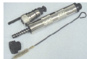
Exemple de pistolet à tige perforante démonté pour entretien
